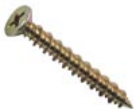
Шуруп повышенной прочности с потайной головкой "Philips №2" двухзаходный. покрытие желтый цинк (для оконных профилей)
